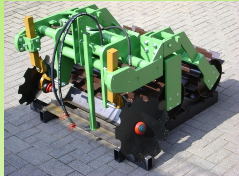
Rolofaca mit verstellbarem Gestell, mit gezackten Scheiben.
